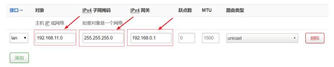
5. 以此类推,将需要增加的目标网段都加入到系统路由表中,最终的配置信息如下,确认信息正确后点击页面下方的"保存并应用"按钮即可立即生效。
